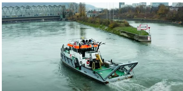
Beseitigung von Auflandungen mit einem Schlickpflug
