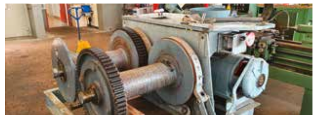
Getriebeumbau des Windenantriebs
